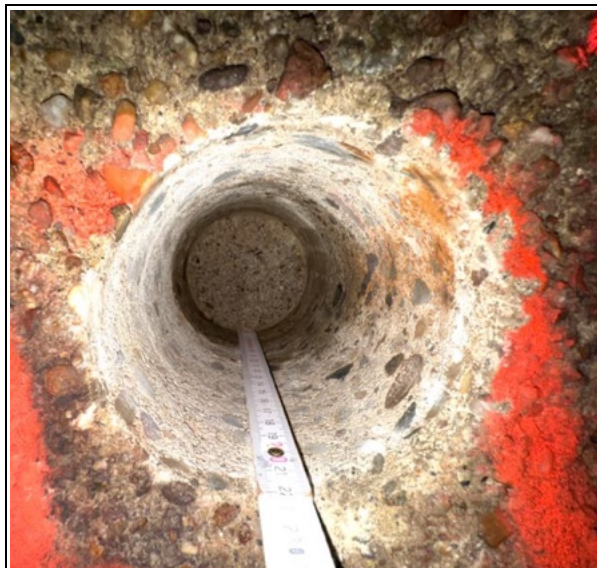
Protokoll ProAn Bild 3: Aufnahme Bohrkernloch.
