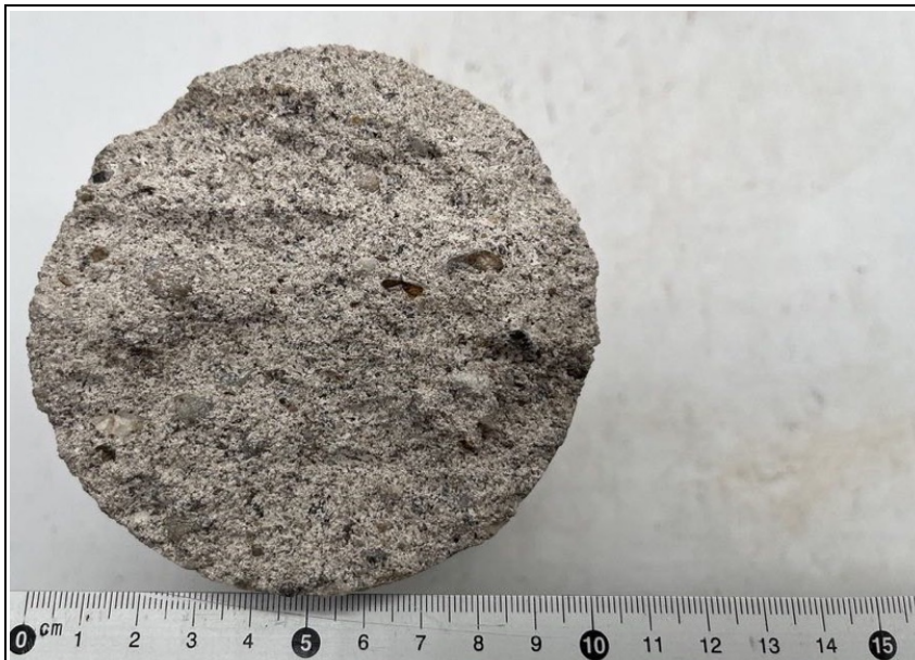
Protokoll ProAn Bild 28: Bruchfläche am Bohrkernende nach Anlieferung, der Bruch verläuft mehrheitlich durch den Feinmörtel
