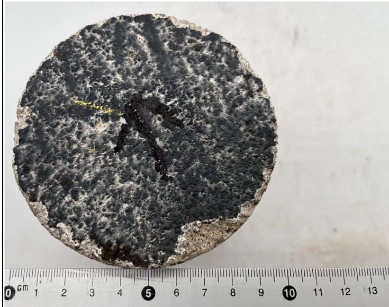
Protokoll ProAn Bild 27: Bohrkernoberseite nach Anlieferung, Pfeilrichtung zeigt bauteilbezogen nach oben, Oberfläche schwarz verfärbt
