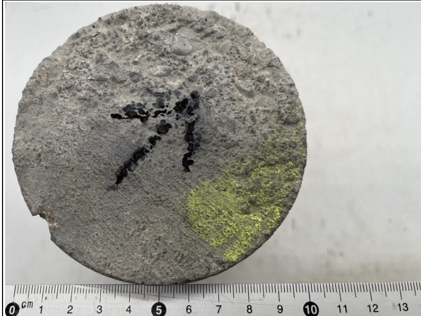
Protokoll ProAn Bild 36: Bohrkernoberseite nach Anlieferung, Pfeilrichtung zeigt bauteilbezogen nach oben, Oberfläche dunkelgrau verfärbt
