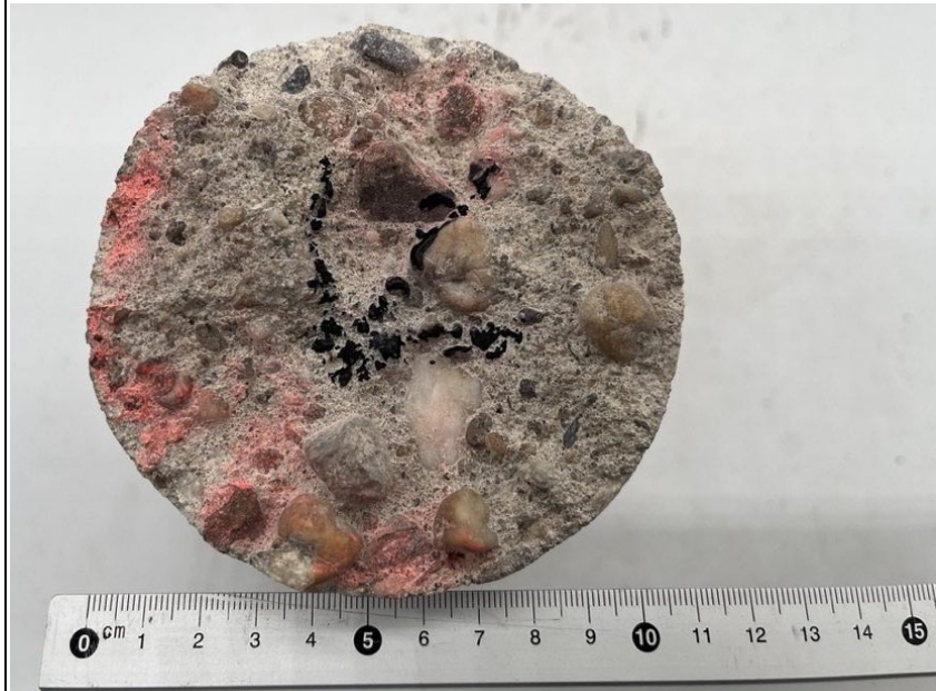
Protokoll ProAn Bild 8: Bohrkernoberseite nach Anlieferung , Gesteinskörnung liegt frei (Abwitterung des Zementleims)
