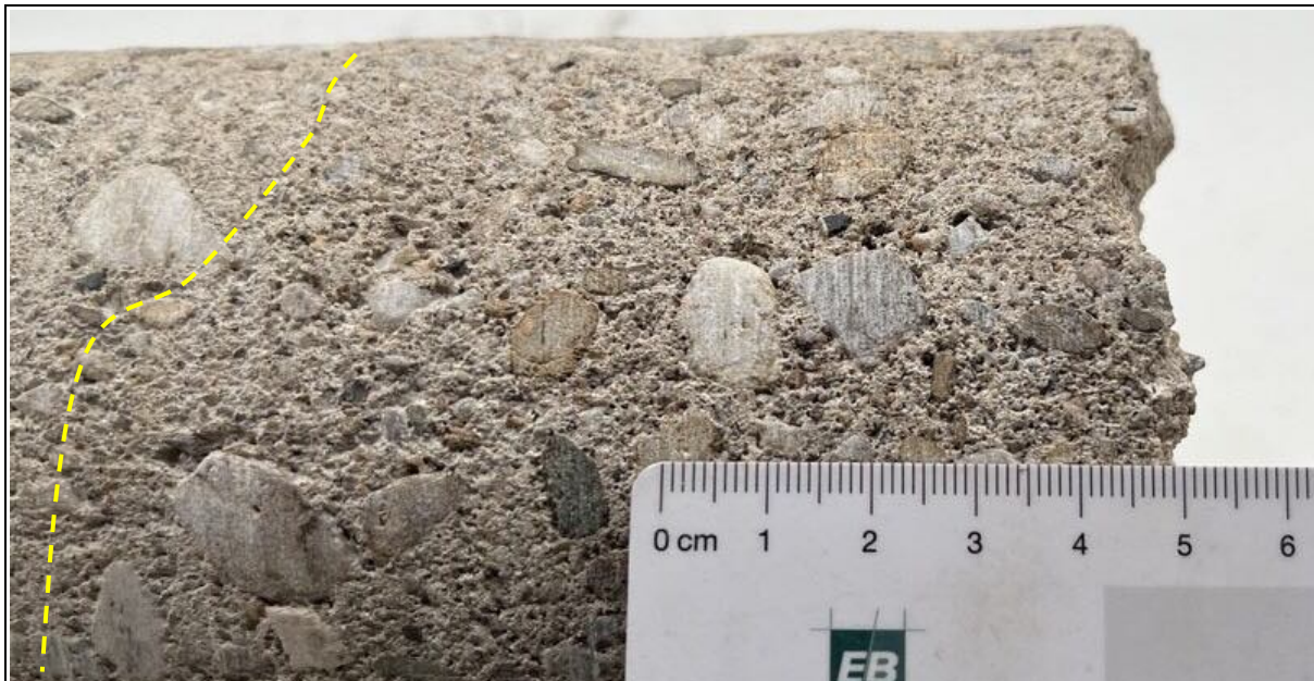
Protokoll ProAn Bild 29: Mantelfläche Detailaufnahme, Tiefe bezogen auf BK Oberseite = 7cm, höhere Porosität
