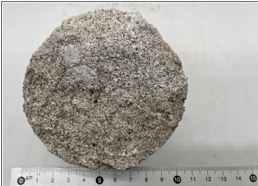
Protokoll ProAn Bild 9: Bruchfläche am Bohrkernende nach Anlieferung, der Bruch verläuft mehrheitlich durch den Feinmörtel
