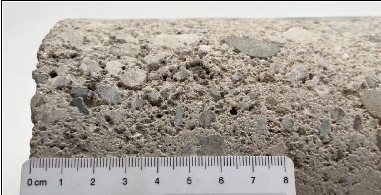
Protokoll ProAn Bild 19: Mantelfläche Detailaufnahme. Hohe Porosität an der Mantelfläche nahe an der Oberseite.
