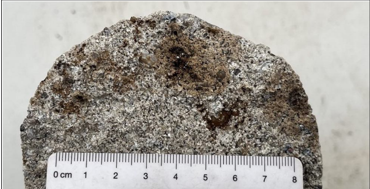
Protokoll ProAn Bild 38: Bruchfläche am Bohrkernende , braune Verfärbungen, vermutlich organischer Herkunft
