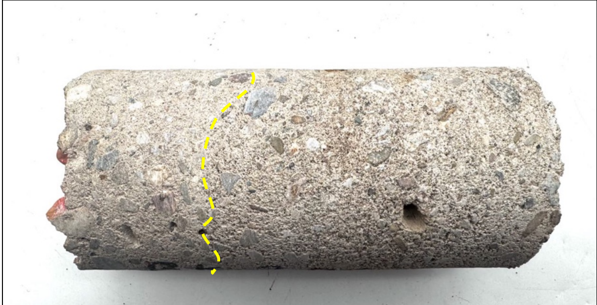
Protokoll ProAn Bild 6: Mantelfläche nach Anlieferung, Tiefe bezogen auf BK Oberseite = 6-5 cm, Gefügewechsel von mehr zu weniger Dichte (mehr verichtungsporen)
