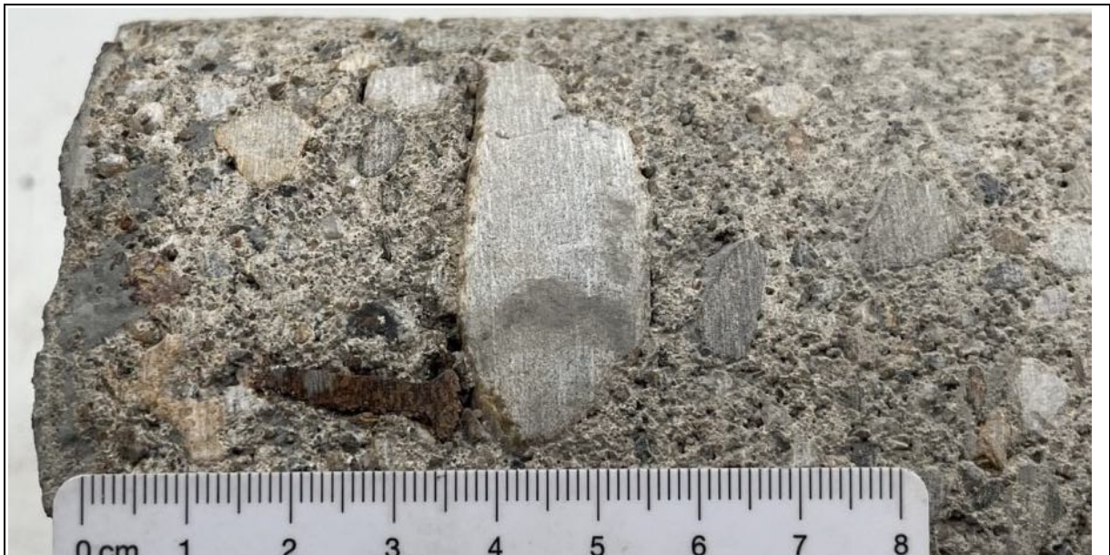
Protokoll ProAn Bild 39: Mantelfläche, Tiefe bezogen auf BK Oberseite = 14cm, Schraube
